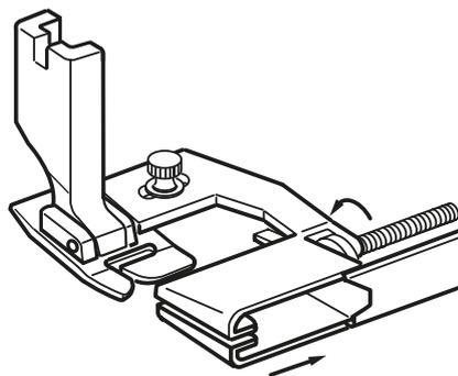
Utilice este prensatelas para fijar la cinta al borde de las telas. Ajuste la posición de caída de la aguja con el tornillo del pulgar. Guíe la tela con la mano izquierda y pegue la cinta con la mano derecha.
