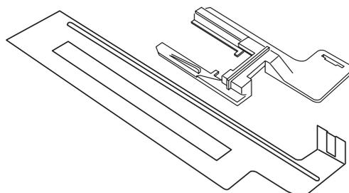
Instalando el prensateclas para ojales R con la placa estabilizadora para ojales, la máquina arrastra diferentes tipos de tejidos y capas irregulares de manera más suave en lugar de comerse el tejido o de bloquear la aguja.
