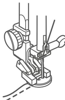
Cosa los botones de manera fácil y rápida con el prensatelas para coser botones. Este prensatelas tiene dos barras fijadas en el soporte del pie que proporcionan una mayor estabilidad, y un manguito de goma para mantener el botón en su sitio mientras cose.
