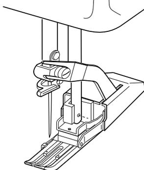
El prensateles de alimentación uniforme pasa por encima de la tela para facilitar la alimentación. La tela se puede coser sin pelucar mientras que la tela se agarró y alimentó por los perros superiores e inferiores de la alimentación. Este prensateles se ha diseñado especialmente para ofrecer durabilidad y para trabajar a altas velocidades de la serie 1600.
