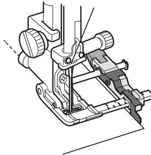
Este prensatelas es ideal para coser a una distancia de 5/8" y dispone de una guía ajustable que permite coser con precisión los bordes y los dobladillos.
