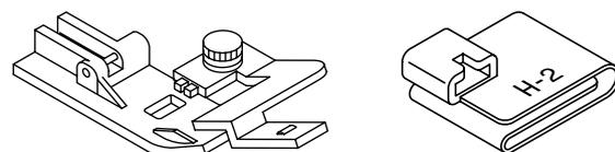
Realice un dobladillo uniforme en los bordes sin necesidad de medir, fijar con alfileres o prensar. Simplemente inserte la tela y la guía se pliega automáticamente y crea un dobladillo de 2,5 cm (1"). Utilícelo con el prensateclas para dobladillos de cobertura.
