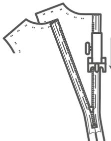
Este prensatelas puede utilizarse para colocar cremalleras invisibles. Las ranuras de la parte inferior acogen los dientes de la cremallera y los mantienen en su sitio mientras usted cose.
