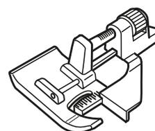
La guía de este prensateclas alinea los bordes de la tela con las costuras para realizar fácilmente costuras de borde paralelas y puntadas de sobrehilado. Ajuste la guía con la ayuda del tornillo para que la costura y el borde coincidan exactamente.
