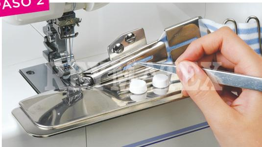
Coloque la cinta a través de la guía tirando suavemente del extremo con la punta de las pinzas.
