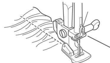
Este prensatelas sirve para realizar fruncidos suaves en telas finas. La parte inferior del prensatelas esta sobrealzada detrás de la aguja y tiene una barra gruesa frente a la aguja para fruncir y poner un volante en una pieza plana al mismo tiempo. Utilice un ondulator para obtener un fruncido aun más espectacular.
